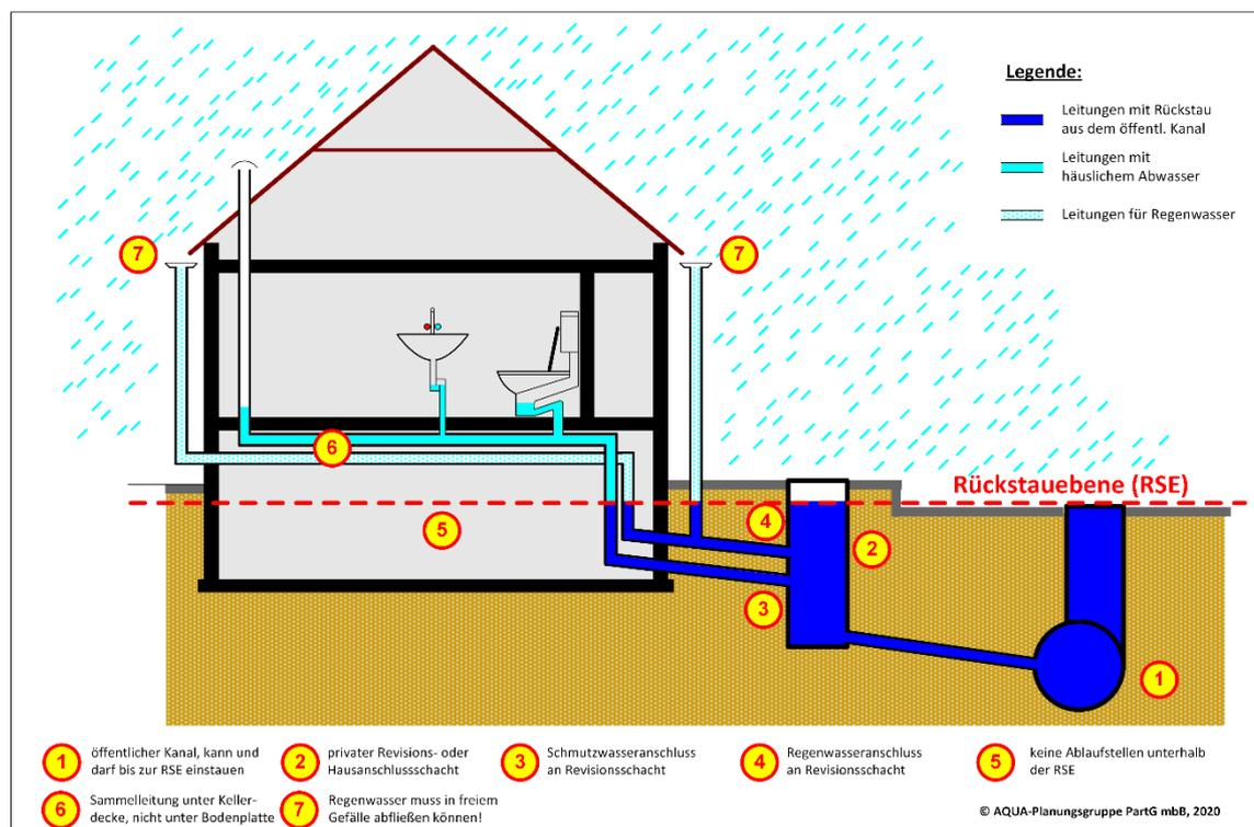
Für Gebäude ohne Keller stellt diese Situation in den meisten Fällen den Normalfall dar. Ein Rückstauschutz wird bei diesen Gebäuden erst dann erforderlich, wenn der Erdgeschossfußboden unterhalb der Rückstaeubene liegt.
