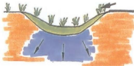
Bei einer Muldenversickerung ( $5 < Au : As < 15$ ) ist je nach Sickerfähigkeit des Bodens eine Sickerfläche zwischen 7 Prozent und 20 Prozent der angeschlossenen Fläche notwendig. Soll eine Versickerung über eine offene Bodenvertiefung mit bewachsener Bodenschicht erfolgen, beträgt deren Tiefe in der Regel maximal 30 cm.
